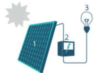
1. Zonnepaneel | 2. Omvormer | 3. Elektrische toestellen
